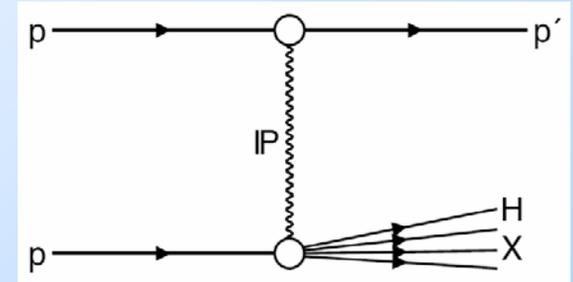
$$\sigma(\text{excl. DPE}) < \sigma(\text{excl. SPE}) < \sigma(\text{incl. SPE})$$
