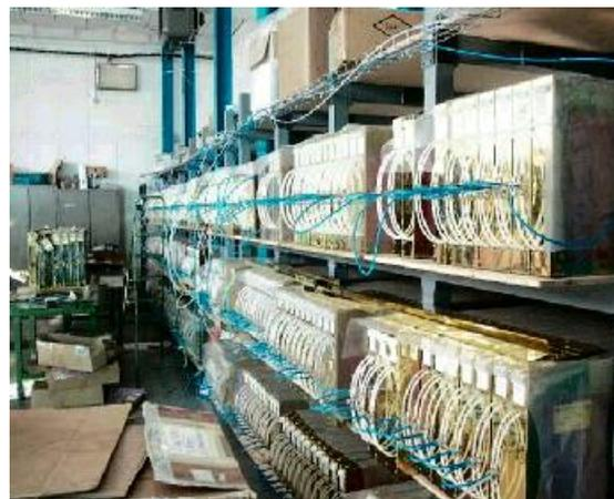
Изготовленные в ПИЯФ мюонные камеры перед установкой в детектор LHCb
