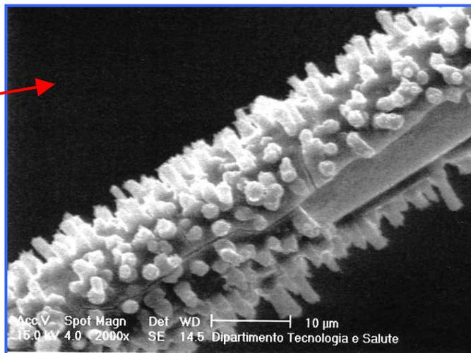
Окисление катода в результате длительной работы приводит к усилению темнового тока, и, как результат, невозможность поднять HV для компенсации падения эффективности
