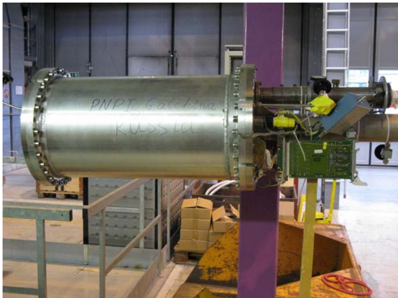
Прототип камеры ACTAR2 E_{\alpha} = 1-10 МэВ The length - 60cm, the inner diameter - 28 cm, working pressure - 10 bar.
