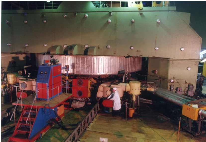
Рис. 2.3. Общий вид синхроциклотрона ПИЯФ 1 ГэВ: слева – генератор ВЧ, справа – нейтроноводы
