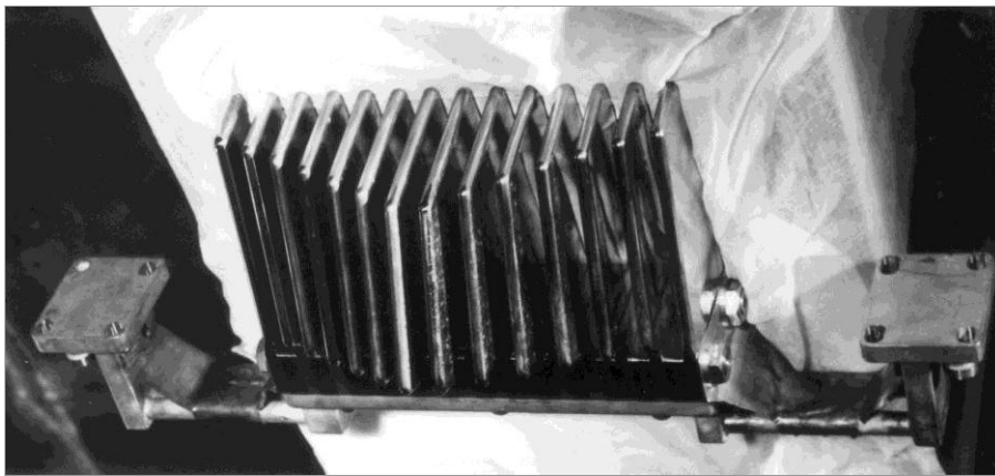
Рис. 6.20. Форма лопаток клиновидных индуктивных пакетов
