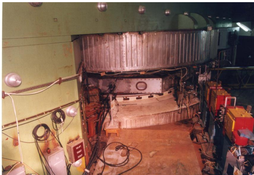
Рис. 2.4. Вид на синхроциклотрон ПИЯФ со стороны вывода протонного пучка (видна система фокусирующих линз тракта вывода пучка)
