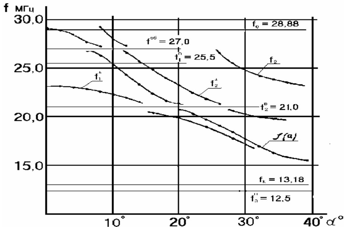
Рис.6. Резонансные частоты ускоряющей системы
