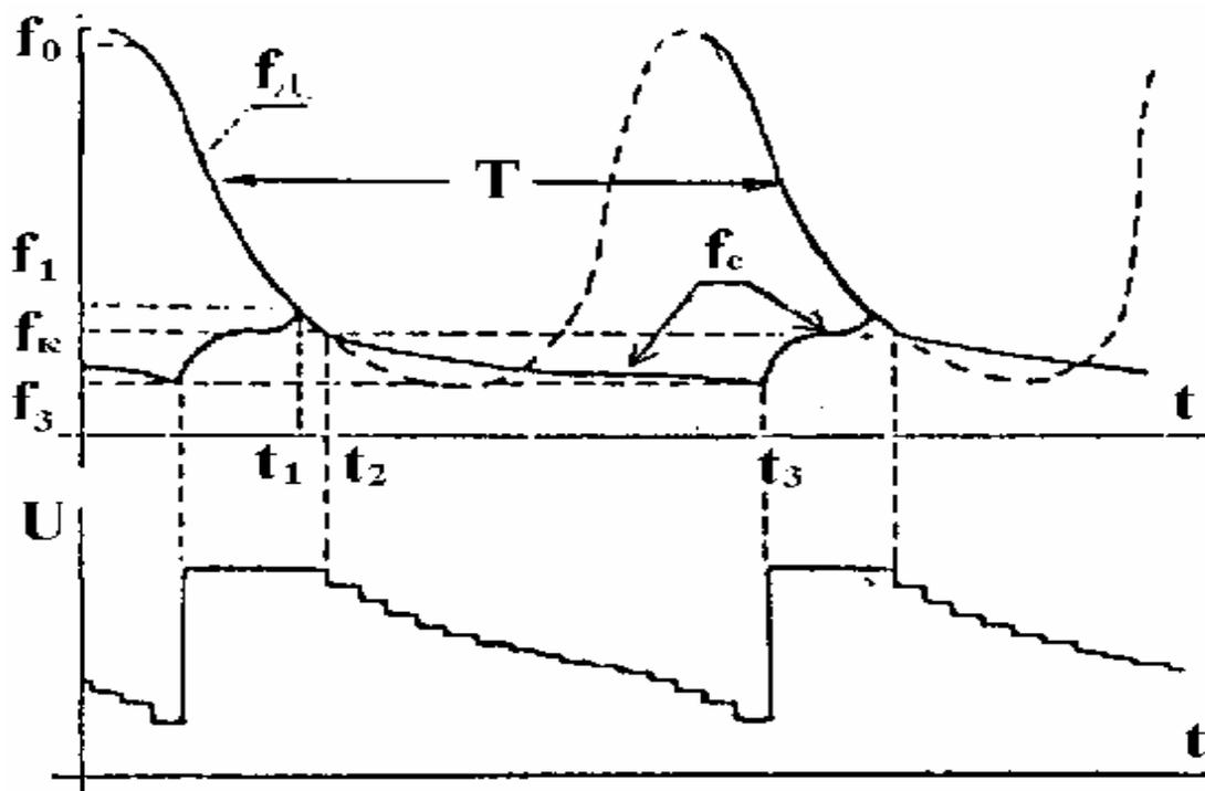
Рис.13. Частотная программа:  $f_d$  - основная,  $f_c$  - Си-электрода,  $U$  - форма напряжения, задающего частотную программу Си-электрода.
