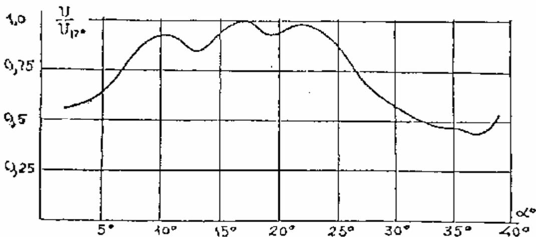
Рис.11. Изменение напряжения на конце дуанта от угла поворота ротора.
