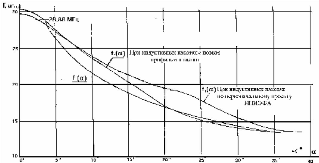
Рис.8. Зависимость резонансной частоты системы от угла поворота ротора вариатора.
