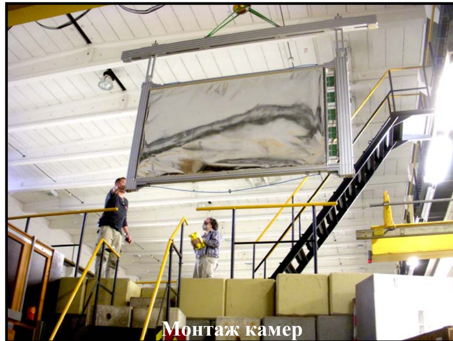
Камеры подготовлены к монтажу в спектрометр
