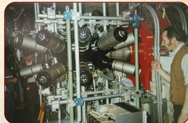
Гатчинская установка для исследования мюонного катализа  $dd$ - и  $dt$ -синтеза на мюонном канале Швейцарской мезонной фабрики
