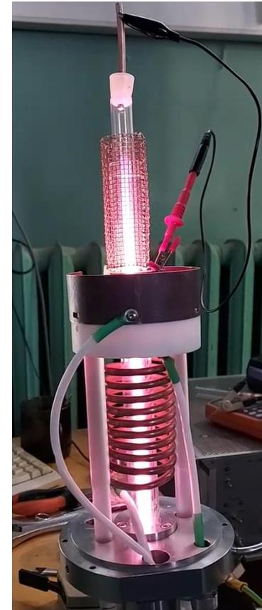
**Параллельный LC контур: Узкая резонансная полоса, сложность в согласовании (обратная мощность на уровне 50%).**
