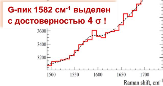
Рамановский спектральный анализ состава микрочастиц и микроструктурированных объектов на образцах катода выполнен прибором Ntegra-Spectra. Длина волны лазера - 532 нм, мощность 22 мВт.
