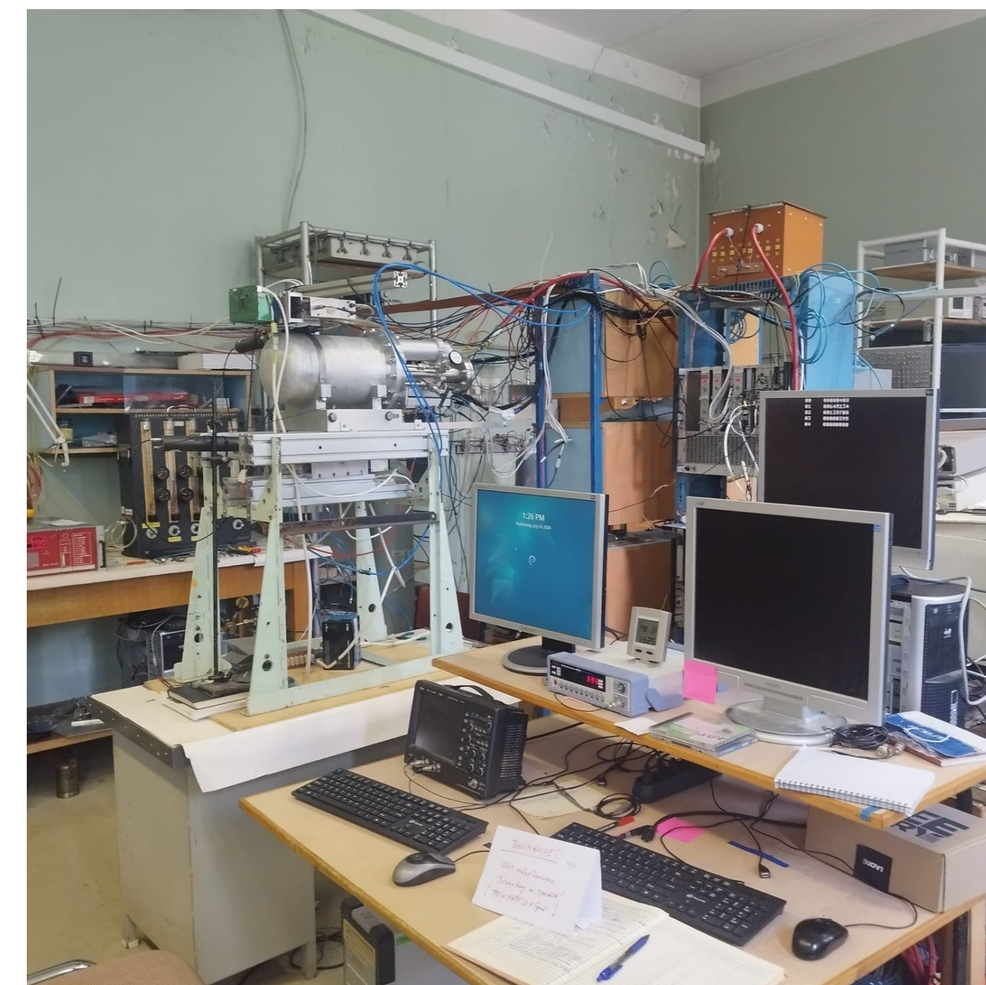
Рис. 25 Тестирование установки на космических лучах (ИК, проп.камеры, счетчики)
