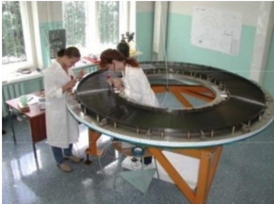
Сборка модулей детектора TRT в ПИЯФ.
