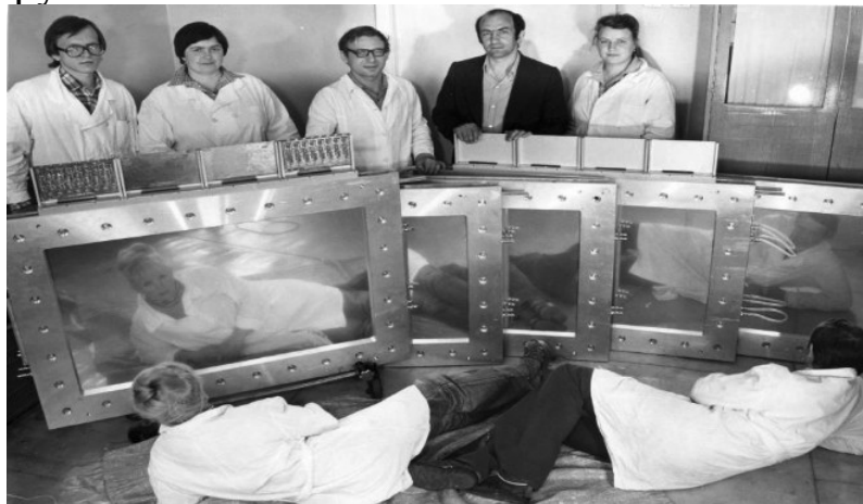
Пропорциональные камеры для детектора переходного излучения, изготовленные в ПИЯФ.
