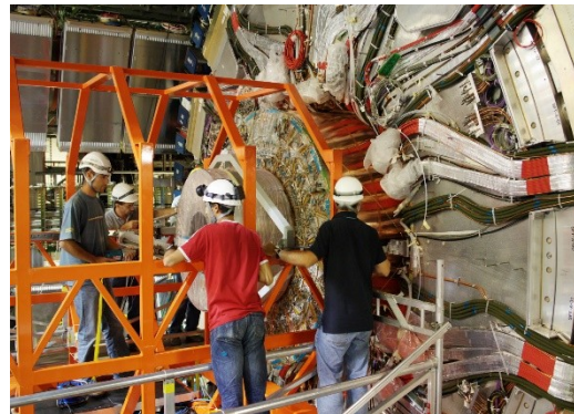
Установка детектора TRT в детектор ATLAS.
