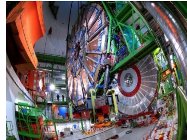
Момент спуска одного из мюонных дисков в подземный зал CMS
