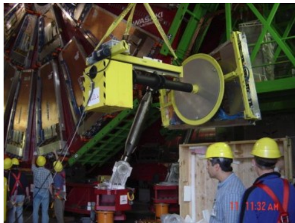
Процесс установки мюонной камеры мюонный диск в наземном зале CMS
