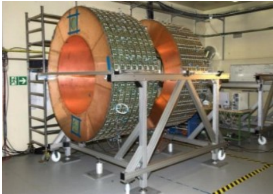
Торцевая часть детектора TRT, собранная из модулей произведенных в ПИЯФ.
