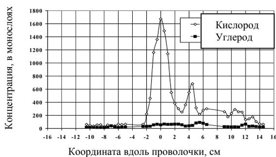
Рис.20б. Распределения концентрации кислорода и углерода вдоль проволоки, полученные методом NRA.
