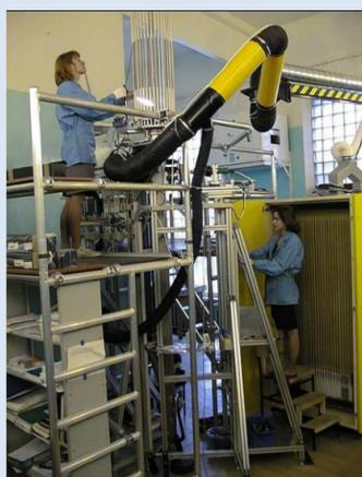
Для армирования дрейфовых трубок в ПИЯФ был организован специализированный участок, на котором было произведено армирование ~110000 дрейфовых трубок длиной 1650 мм. Контроль качества произведенных трубок включал проверку расслаивания армирующих нитей из углеволокна и измерения геометрии трубок (кривизна, внутренний и внешний диаметры, отсутствие локальных деформаций или дефектов). При производстве ~6000 трубок в месяц выход дрейфовых трубок требуемого качества составил 98%.
