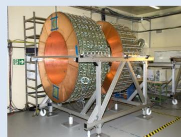
В 2004–2006 гг. в ЦЕРН при участии сотрудников лаборатории была произведена сборка всех торцевых модулей детектора TRT в единое целое – торцевые части детектора TRT. Были проведены окончательные испытания электроники детектора, высоковольтной системы, системы охлаждения детектора, и проверена герметичность системы снабжения газовой смесью. В 2008 году детектор был установлен в шахте эксперимента и введен в эксплуатацию.
