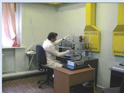
Перед сборкой модулей детектора TRT, трубки проходили через несколько этапов проверки:
