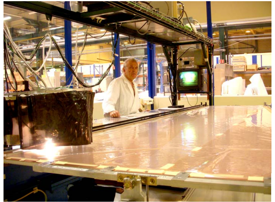
Пайка провололочек на анодную панель
